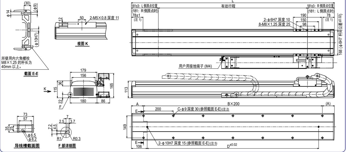
N18 安装方法: 壁挂/标准导线槽规格 RW
